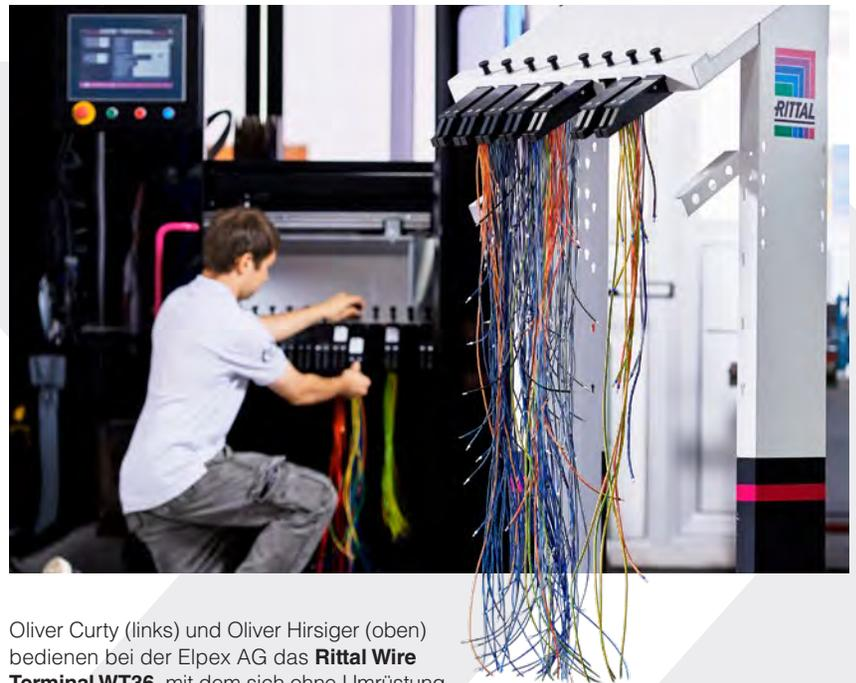
Oliver Curty (links) und Oliver Hirsiger (oben) bedienen bei der Elpex AG das **Rittal Wire Terminal WT36**, mit dem sich ohne Umrüstung bis zu 36 unterschiedliche Drähte in den Querschnitten von 0,5 mm<sup>2</sup> bis 6 mm<sup>2</sup> vollautomatisiert ablängen, abisolieren, crimpen, beschriften und auftragsbezogen sortieren lassen.
