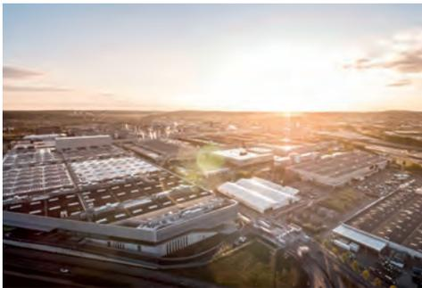
**Grüner Strom direkt vom Dach der Factory 56:** 12.000 PV-Module erzeugen 5.000 MWh Strom, die direkt genutzt, zwischengespeichert oder ins öffentliche Netz eingespeist werden.
